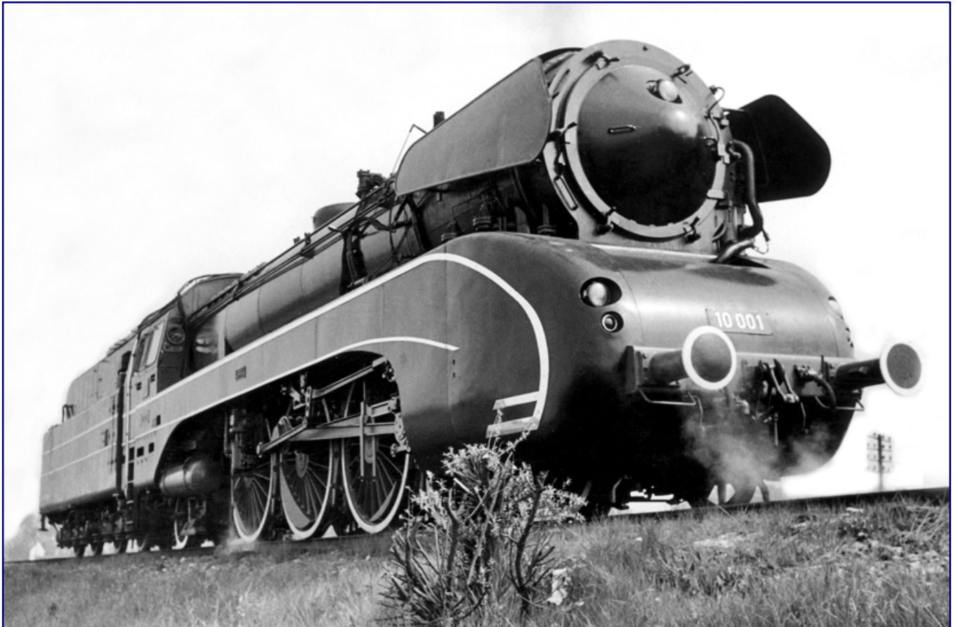
Nach langen Überlegungen erhielt die beiden Maschinen der Baureihe 10 eine Stromlinienteilverkleidung in klassischer Lackierung. Für Eleganz sorgten aufgesetzte Zierlinien und die Witte-Windleitbleche in einer Sonderbauform. Die frisch abgelieferte 10 001 präsentiert sich ihrem Fotografen 1957 bei Minden in Ursprungsbauforn mit Dreiklangpfeife und Abdeckklappe auf dem Kohlenkasten des Tenders. Foto: Bustorff, Bildarchiv Eisenbahnstiftung
