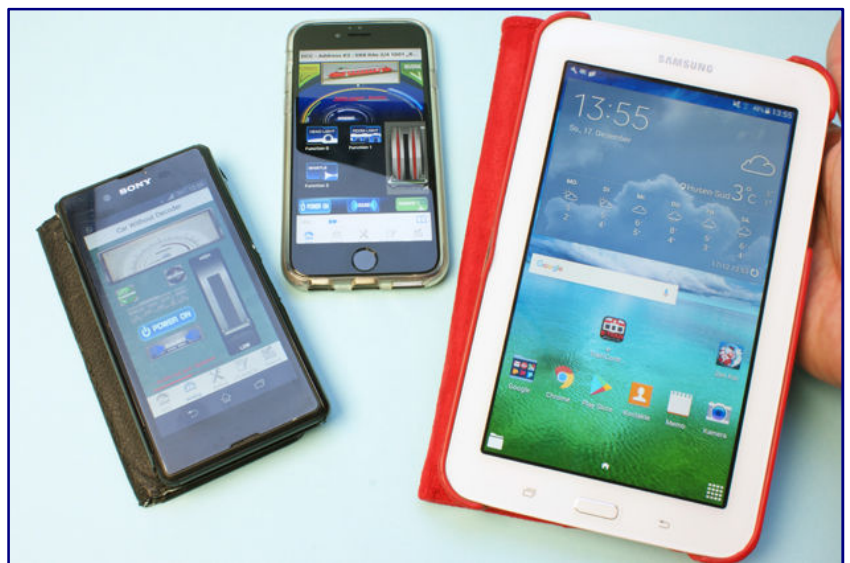
Rokuhans Zentrale bedient sich eines modernen Mobiltelefons oder Tablettechners zur Erzeugung der Signale – ohne funktioniert es nicht.
