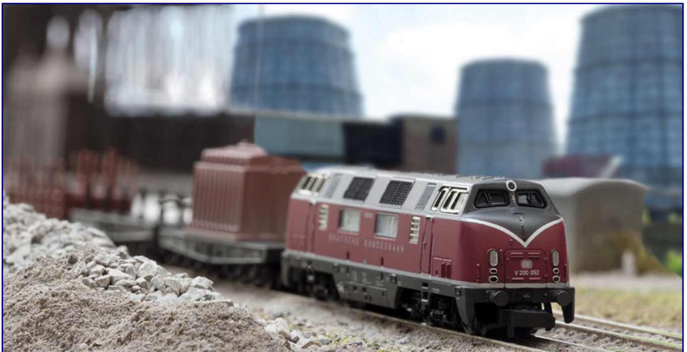
Die V 200 wird auf den Glockenankerantrieb umgebaut und erscheint erstmals als Lok aus dem ersten Krauss-Maffei-Baulos (88203, am Muster noch nicht ersichtlich). Im Schlepp hat sie die im Text erwähnten Wagen zum Thema Stahltransport. Foto: Märklin
