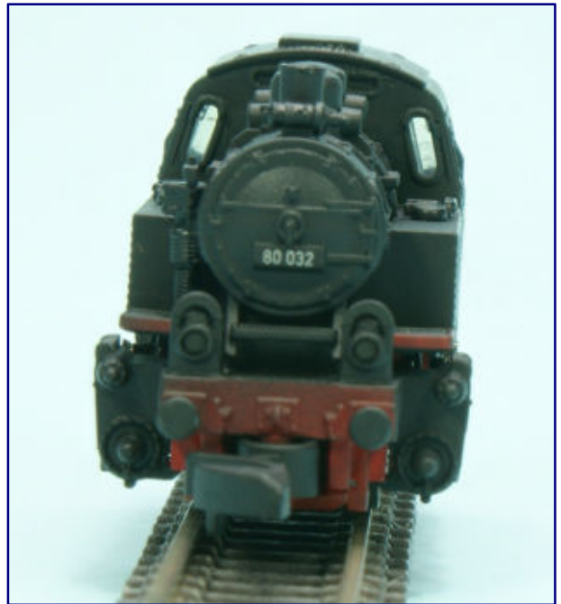
Bei der Sicht von vorn fällt auf, dass die Dampfzylinder die größte Breite der Lok bestimmen – beim Vorbild war es das Führerhaus, von dem wir auch das Vergleichsmaß abgenommen haben.
