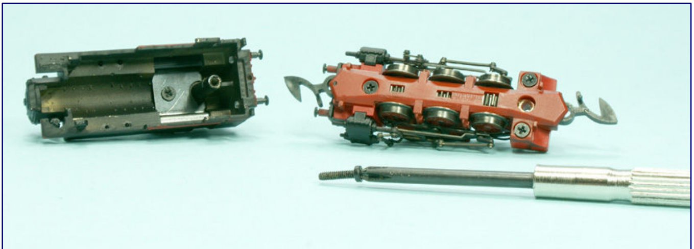
Die Abnahme des Gehäuses verläuft etwas ungewöhnlich: Die Getriebeabdeckung ist hinten mit drei Schrauben gesichert, die mittlere greift durch das Fahrwerk hindurch in einen Steg des Gehäuses im hinteren Führerstands Bereich.
