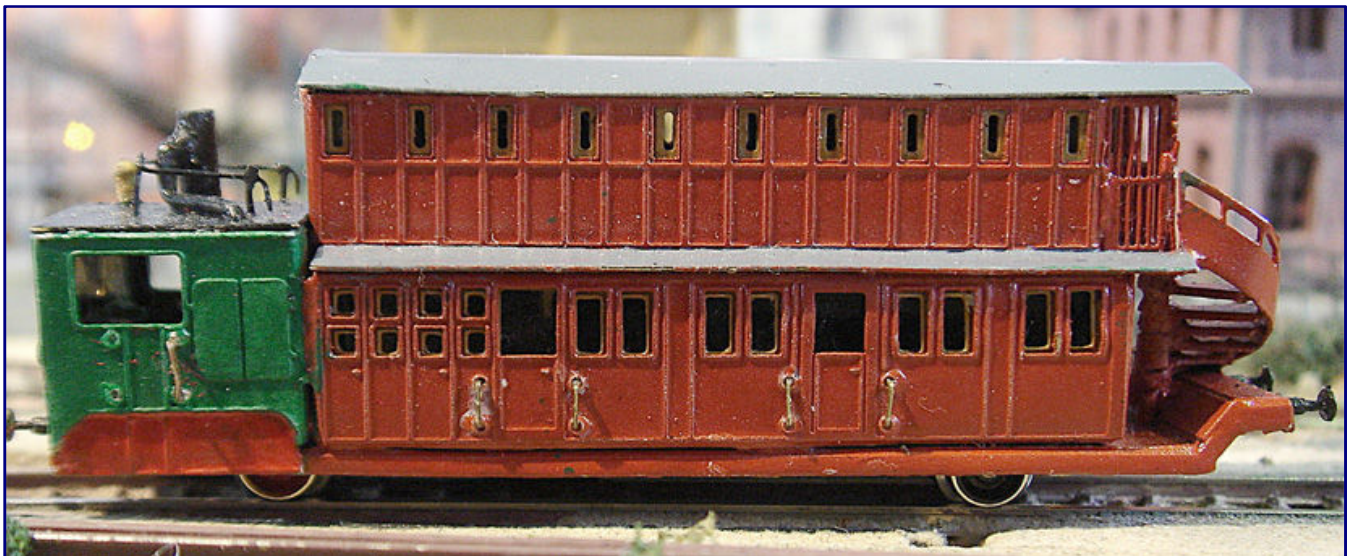
Mit einem unter dem Betriebsnamen „Glück auf“ eingereichten Thomas-Dampftriebwagen begann bei der Hessischen Ludwigsbahn die Ära solcher Nebenbahnfahrzeuge mit stehenden Kesseln. Das Bild zeigt ein ähnliches, aber längeres Modell auf der Anlage von Wolf-Ullrich Malm.
