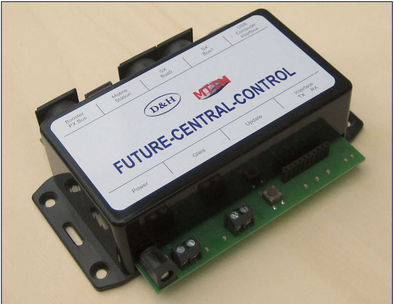
Die FCC (Future-Central-Control) von Doehler & Haass gehört zu den Digitalzentralen, an die ein Handregler mit Anzeige oder aber ein Computer separat angeschlossen werden müssen. Foto: Andreas Hagendorf
