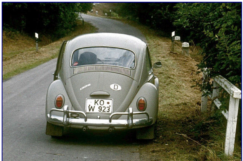
Dieser VW 1300 von 1966 gehört der „neuen Form“ an. Das Heck zieren nun die Bügeleisen-Rückleuchten. Foto: Lothar Spurzem, CC-BY-SA-2.0-DE
