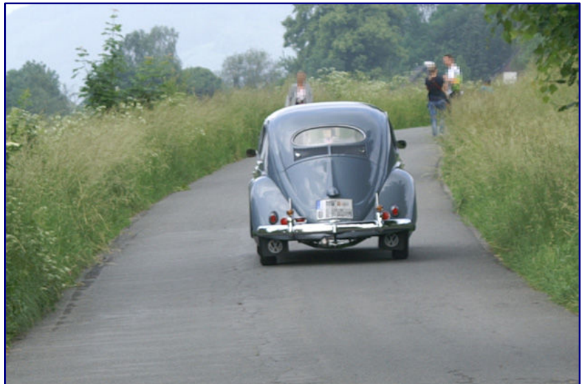
Mit dem Modelljahr 1954 verlor der Käfer den hinteren Fenstersteg. Nach den Werksferien 1953 trat er als „Ovali“ auf: Das neue einteilige Heckfenster behielt aber dieselben Außenmaße.
