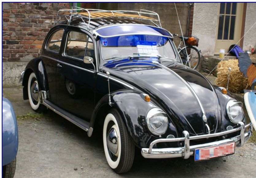
Auf „Ovali“ folgten ab Baujahr 1957 „Dickholmer“ mit größerem Rechteckfenster. Charakteristisch blieb das Wolfsburg-Wappen über dem vorderen Haubengriff. Dieses Exemplar besitzt zudem die sogenannten Rammstoßstangen.
