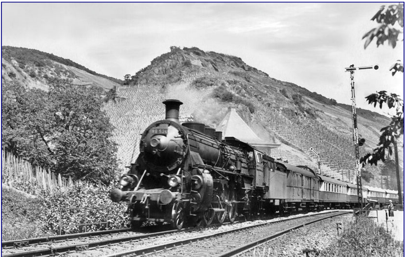
Als 18 524 im Jahre 1930 mit dem FFD 102 „Rheingold“ die Blockstelle Peternach bei Boppard südwärts passiert, besitzt sie bereits eine elektrische Beleuchtung, aber noch keine Windleitbleche. Außergewöhnlich erscheint aus heutiger Sicht auch das Hauptsignal mit dem als Negativzeichen ausgeführten Flügel. Foto: DLA Darmstadt (Maey) / Eisenbahnstiftung
