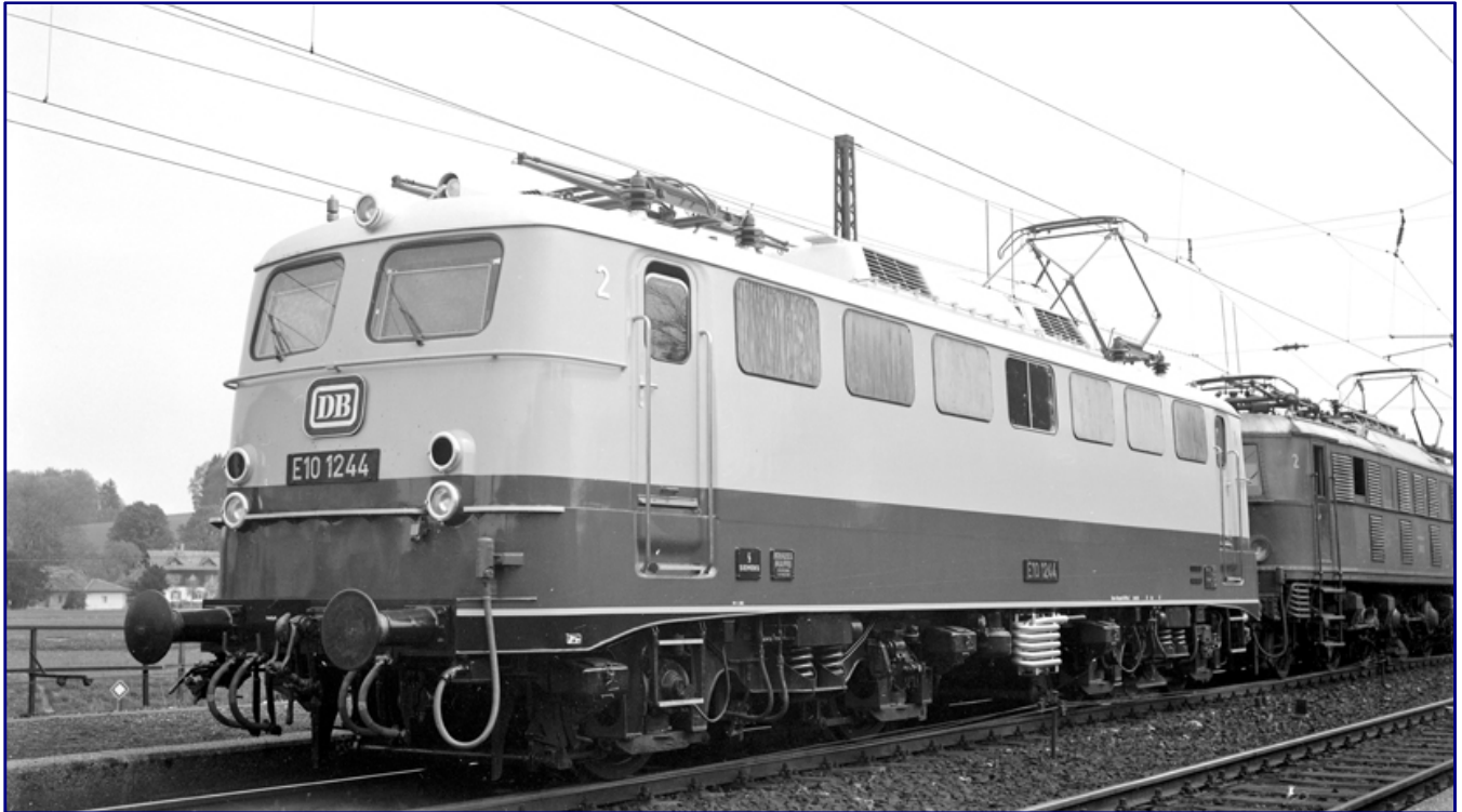
1962 sollte der Rheingold wieder als Luxuszug in zeitgemäßer Form an den Start gehen. Da die „Bügefalten“ nicht rechtzeitig fertig wurden, kamen mit Henschel-Versuchsdrehgestellen ausgerüstete E 10 aus der laufenden Fertigung als Provisorium zum Einsatz. Eine von ihnen war 10 1244, die der Fotograf am 9. Mai 1962 zufällig bei einer Probefahrt im Bahnhof Prien erwischte. Foto: Ron Amberger / Eisenbahnstiftung
