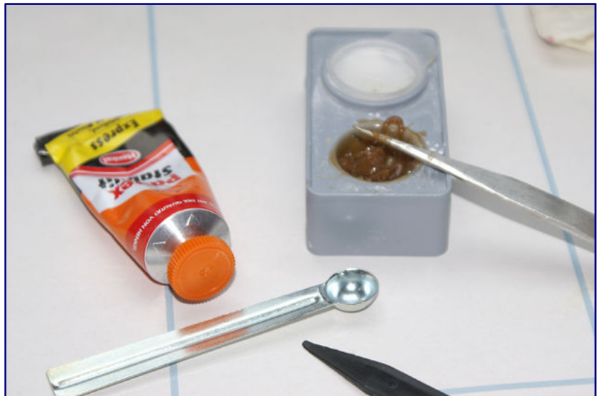
Mit Pattex Stabilit Express werden das Zinkdruckguss- und das Messingussteil dauerhaft verbunden. Zunächst wird der Klebstoff tief in die Bohrlocher gespachtelt, bevor die Klebnaht zwischen beiden Hälften folgt.
