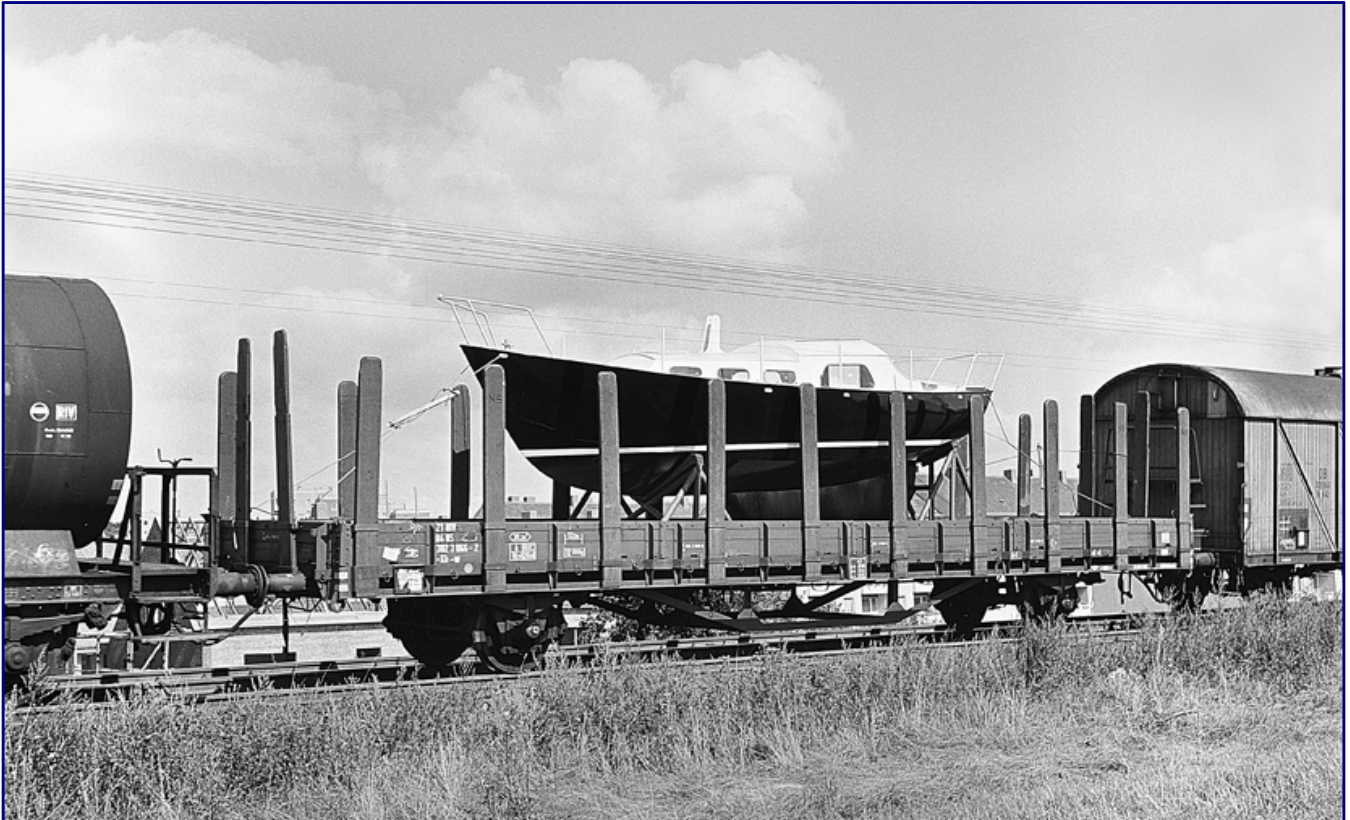
Auch viele ungewöhnliche Transporte mit Rungenwagen sind dokumentiert und bieten vielfältige Anregungen für den Einsatz auf der Modellbahn. So befördert dieses mit Holzrungen und -borden ausgestattete Exemplar der NS am 29. Juli 1966 ein Segelboot – der Waggon fällt im Zugverband gleich auf. Foto: Joachim Claus / Eisenbahnstiftung
