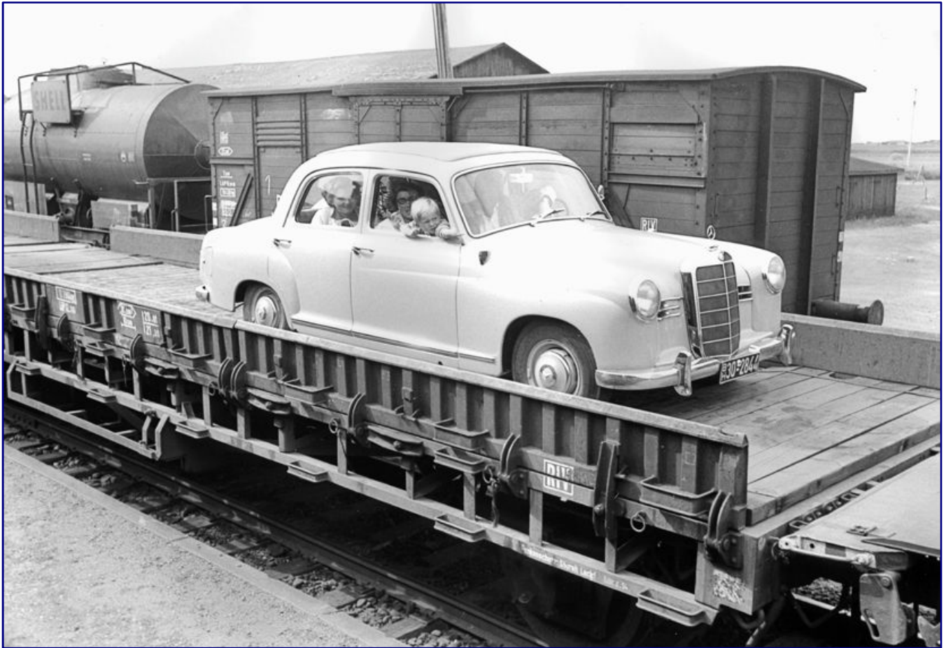
Auch Kraftfahrzeuge verschiedener Art gehörten zu den typischen Ladegütern von Niederbord- und Rungenwagen. Zwischen 1950 und 1953 stattete die DB für den Sylt-Verkehr 25 Wagen mit Heizleitung aus, um sie zwischen Lok und Reisezugwagen einzustellen. 1955 fährt ein Mercedes-Benz 180 D mit Ponton-Karosserie in Niebüll auf einen Rungenwagen der Bauart Rmmhs 31. Foto: Walter Hollnagel / Eisenbahnstiftung
