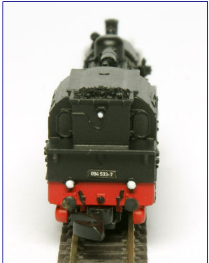
Mit Ätzteilen wurde auch eine in Form und Größe korrekte Nachbildung der Führerstandsrückfenster erreicht.
