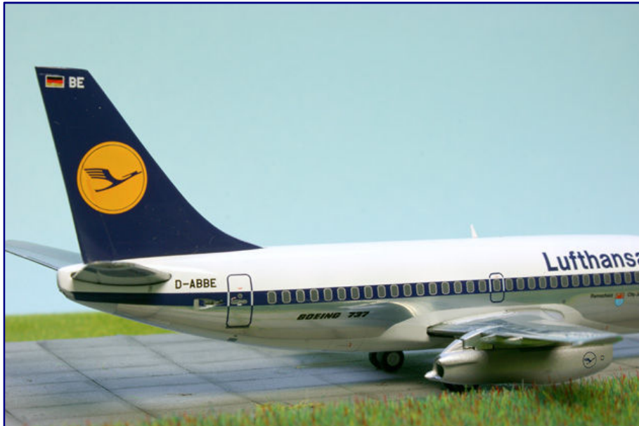
Erkennungsmerkmale der Boeing 737-200 sind die Form des Seitenleitwerks, auf dem die Lufthansa ihr „Spiegelei“ anbrachte, und die hinten überstehenden, schlanken Triebwerke vom Typ P&W JT8D.
