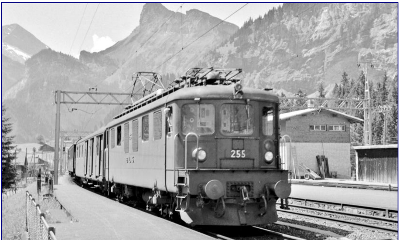
Die Ae 4/4 der BLS war eine laufachslose Ellokomotive, an der sich die DB orientieren konnte. 1944/45 wurden zunächst zwei Exemplare beschafft, bis 1954 folgten sechs weitere. Hier fährt die Ae 4/4 255 im Juni 1956 mit Schnellzug 133 in Kandersteg ein. Foto: Kurt Eckert, Sammlung Eisenbahnstiftung
