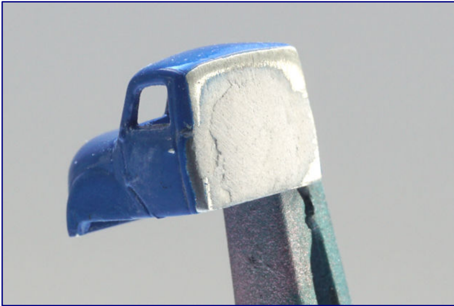
Bevor der ausgebesserte Bereich in der Kabinenfarbe neu lackiert werden kann, muss die Fläche erst glattgeschliffen werden.
