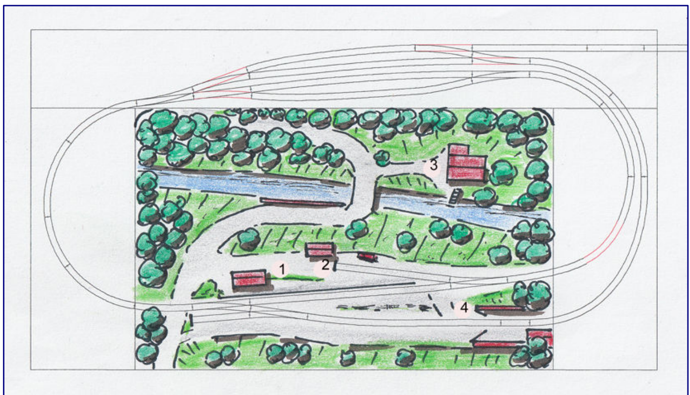
Der einfache Gleisplan (Bild oben) mit den Zentimeter-Maßen zu den Abschnittsteilungen und mit der Landschaftszeichnung (Bild unten) zur Visualisierung der dargestellten Landschaft (1 Depot, 2 Freiladegleis, 3 Farmhaus, 4 Einfahrt Gewerbeunternehmen)
